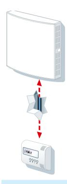
Für das Lüftungsgerät ist lediglich eine Bohrung und das bauseitige Verlegen der Stromkabel notwendig.
